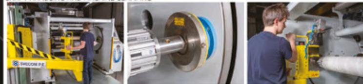
Il nostro mod. 10 semplifica il carico e lo scarico di alberi espandibili in modo **sicuro e senza sforzo**. Disponibile assieme a carrelli per ottenere una soluzione di movimentazione **semiautomatica**.
