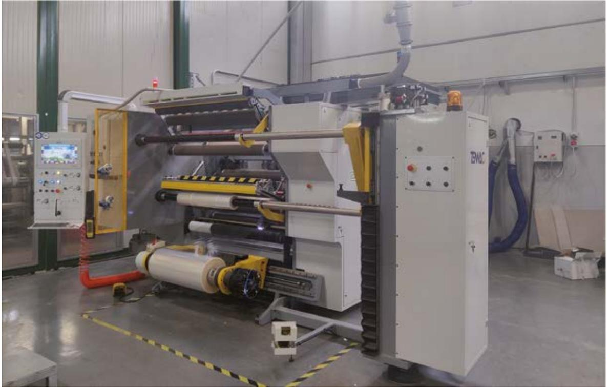
Nella configurazione macchina a 3 o più motori, inoltre, anche la SRS 861 può contribuire al risparmio energetico, poiché il motore in svolgimento anziché causare dispersione di energia nell'ambiente sotto forma di calore (come farebbe un comune asse gestito da freno), funge da generatore di energia, energia che viene poi utilizzata dalla macchina stessa.
