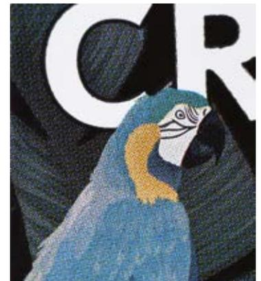
**Gli inchiostri a base acqua presentano un minor aumento del punto rispetto agli inchiostri a solvente e i punti delle mezzetinte risultano più incisi e nitidi / Water-based inks have a lower dot gain than SB inks, the halftone dots print out sharper and more pointed.**
