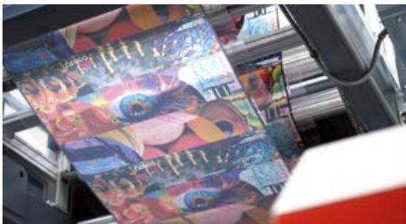
l'ottimizzazione del consumo energetico durante la fase di asciugatura, regolando la potenza di asciugatura in base alle caratteristiche di stampa, e coprenza dei colori, identificate da Active Start. Questo approccio mirato può ridurre il consumo energetico del processo di asciugatura fino al 50%, offrendo vantaggi ambientali e risparmi economici molto significativi.
